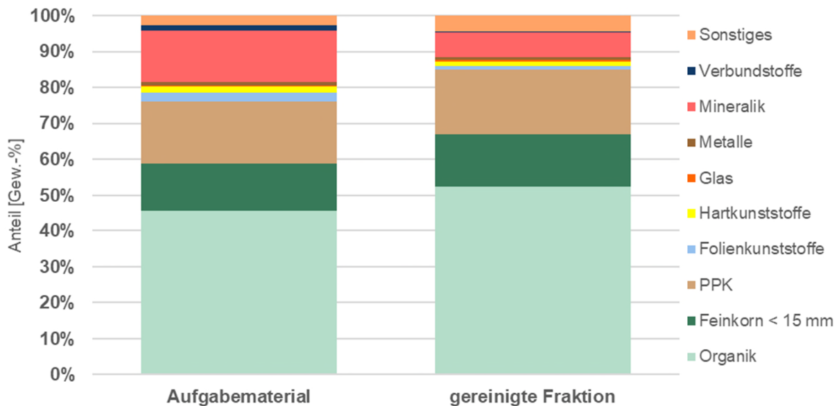
Abb. 95: Zusammensetzung des Aufgabematerials und der gereinigten Fraktion nach Durchgang 1
