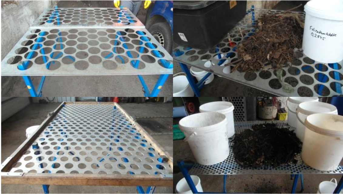
Abb. 14: Aufbau zur händischen Sortieranalyse von Siebüberläufen
