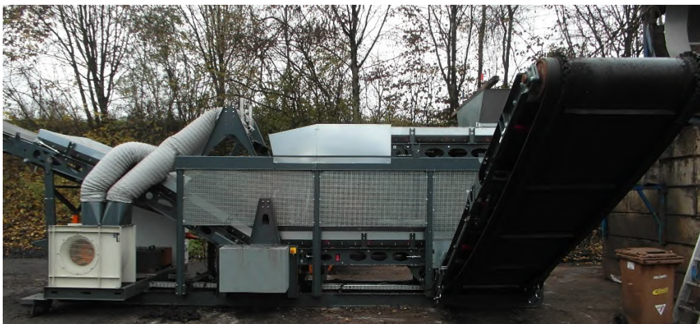
Abb. 92: „Windbreeze“ (ENVITAL GmbH): Kombination aus Windsichter und Schwerstoffabscheider
